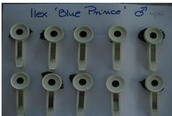
Ryc. 4. Pomiar fluorescencji chlorofilu a Ilex meserveae 'Blue Prince', przy użyciu 'dark leaf clip' [fot. Karolina Wietnik].
