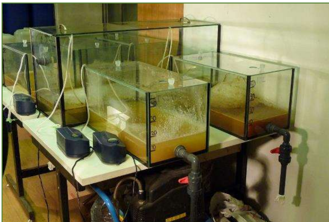
Ryc. 12. Bioreaktory z hodowlą biopreparatu ZB-01, Zespół Biochemii, KBRiB, UR
