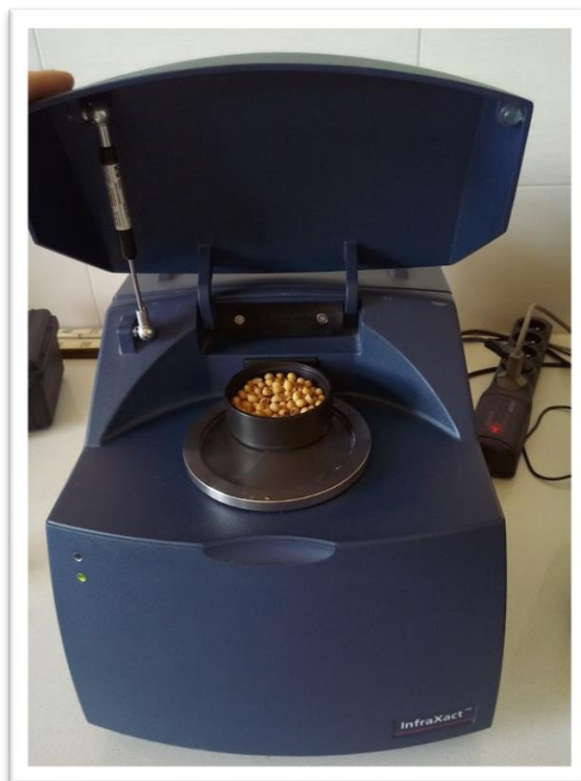
Fot. 27. Oznaczanie zawartości białka i tłuszczu za pomocą FOSS A/S – InfraXact (NIRS); Pic. 27. Determination of protein and fat content with FOSS A/S - InfraXact (NIRS)
