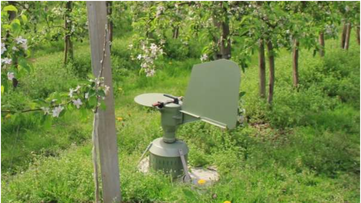
Ryc. 5. Spore Trap do monitoringu zarodników grzybów (fot. K.Gasparski)
