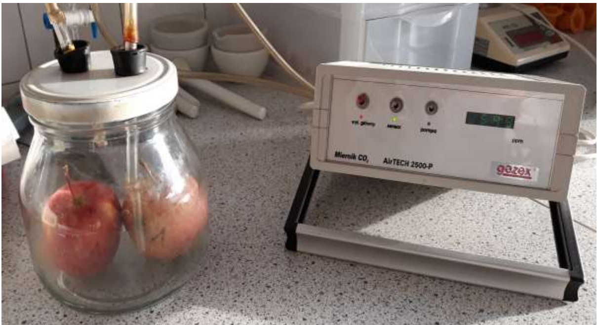
Ryc. 13. Miernik do pomiaru intensywności oddychania owoców (fot. K.Gasparski)
