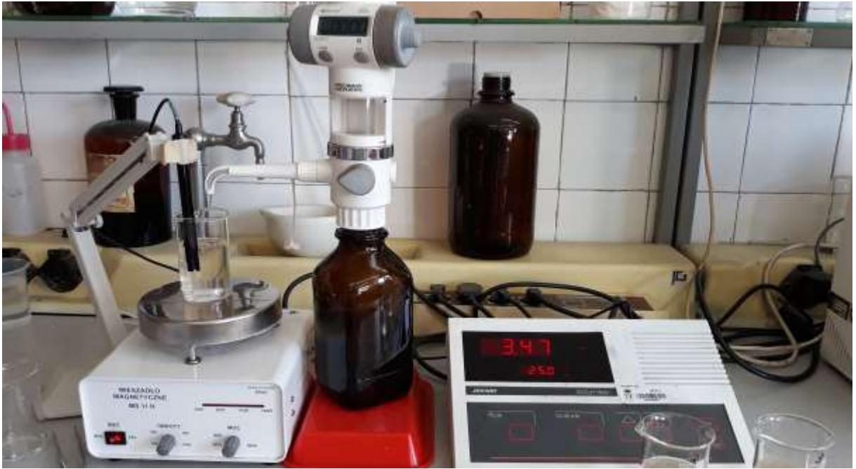
Ryc. 12. Zestaw do określania kwasowości miareczkowej (fot. K.Gasparski)
