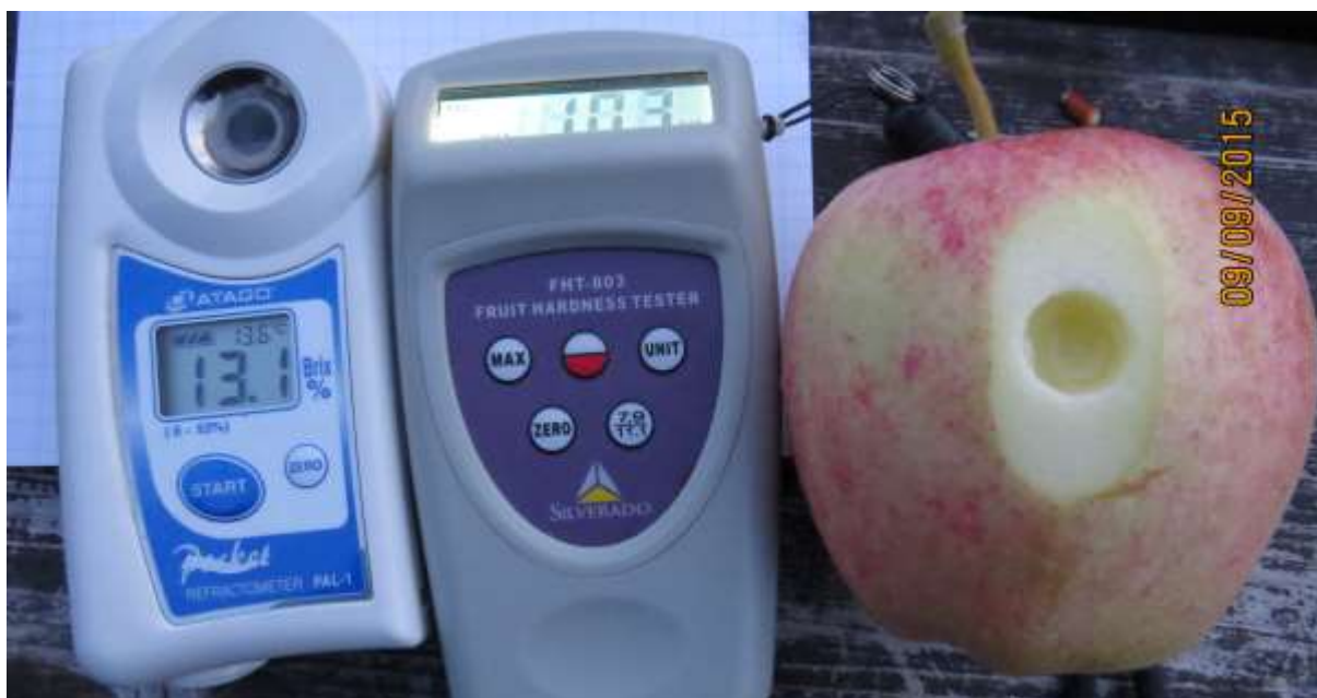
Ryc. 9. Refraktometr i jędrnościomierz do wstępnej przedzbiorczej oceny dojrzałości owoców (fot. K. Gasparski)
