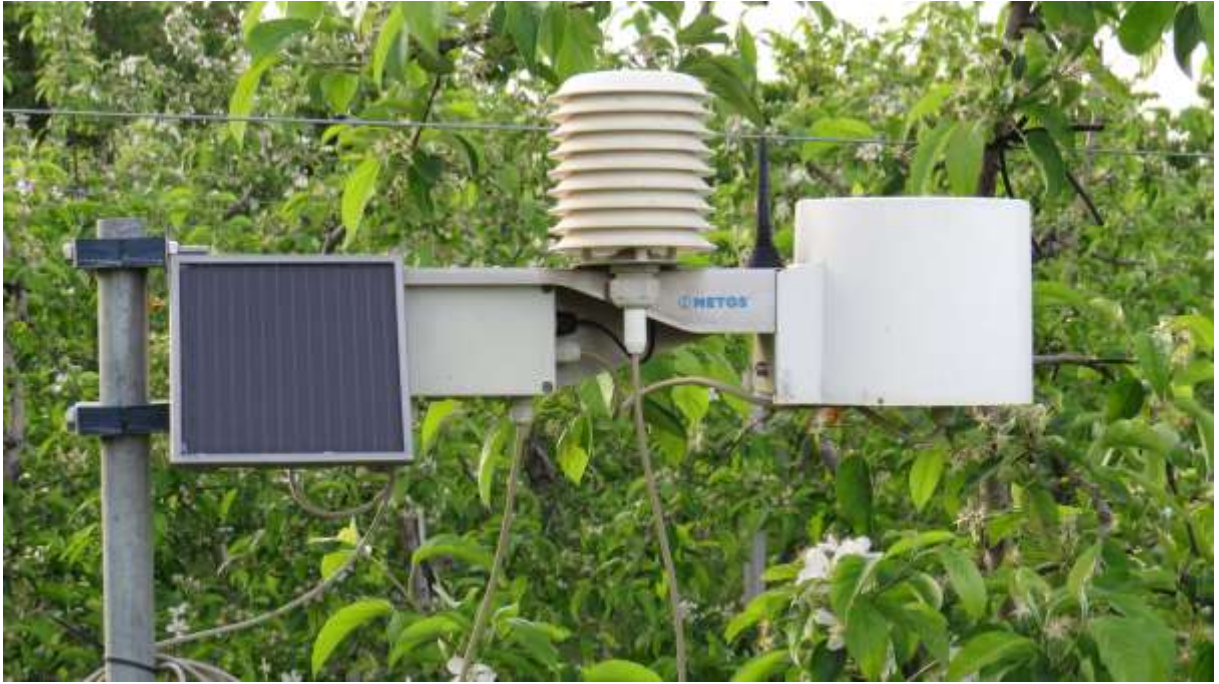
Ryc. 4. Stacja meteorologiczna I'Metos z modelami chorobowymi firmy Pessl Instruments (fot. K.Gasparski)
